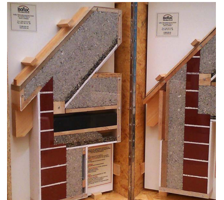
Bau- und Dämmmaterial begünstigt Kühlung
